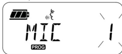
Le réglage actuel du niveau de gain du microphone auxiliaire clignote à l'écran de la radio. Vous pouvez sélectionner le niveau de gain du microphone auxiliaire désiré (1 = gain faible, 2 = gain moyen ou 3 = gain élevé) en appuyant sur les boutons programmables A et B.
