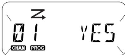
Le numéro de canal et le paramètre de balayage en cours (OUI = Activé ou NON = Désactivé) clignotent à l'écran pour indiquer que vous pouvez sélectionner votre réglage. Pour régler le numéro de canal, tournez le bouton sélecteur de canal jusqu'au canal désiré.
