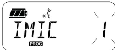
Le réglage actuel du niveau de gain du microphone clignote à l'écran de la radio. Vous pouvez sélectionner le niveau de gain du microphone désiré (1 = gain faible, 2 = gain moyen ou 3 = gain élevé) en appuyant sur les boutons programmables A et B.
